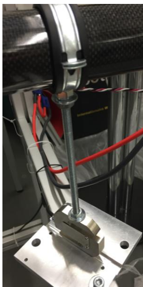
Figura 6.3 Nueva Fijación de la célula de carga
