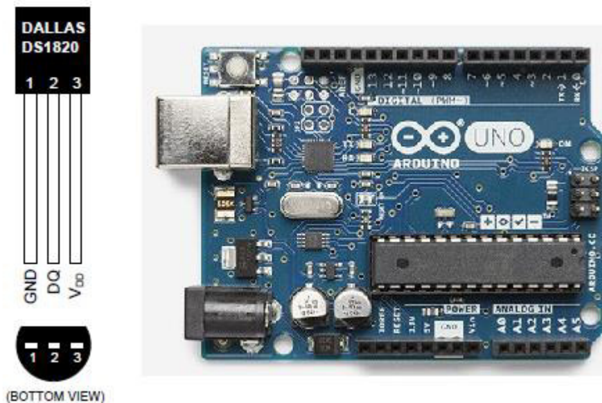
Abbildung 7.7 Temperatursensor DS18s20 von DALLAS [14] und Arduino Uno [15]
