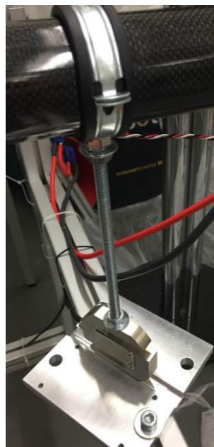
Abbildung 8.5 Befestigung der Wägezelle
