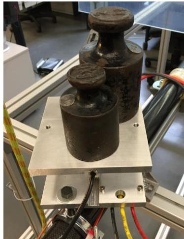
Abbildung 7.1 Gewichte werden auf Motorbefestigung aufgelegt
