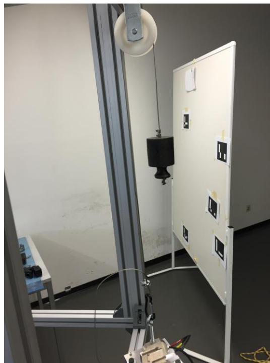
Abbildung 7.5 Symmetrische Aufhängung des Gewichts
