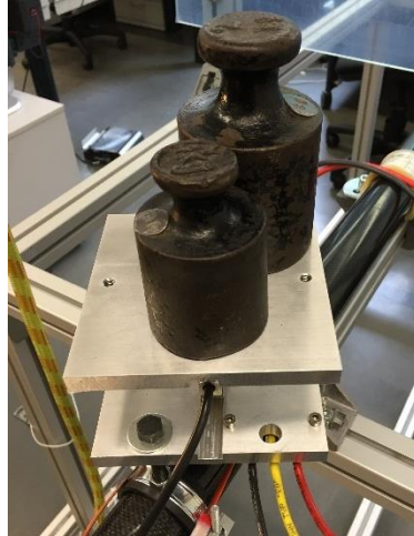
Figura 5.1 Los pesos se colocan sobre la célula de carga
