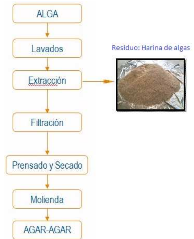
Figura 1: Esquema del proceso industrial de obtención del Agar-Agar.
