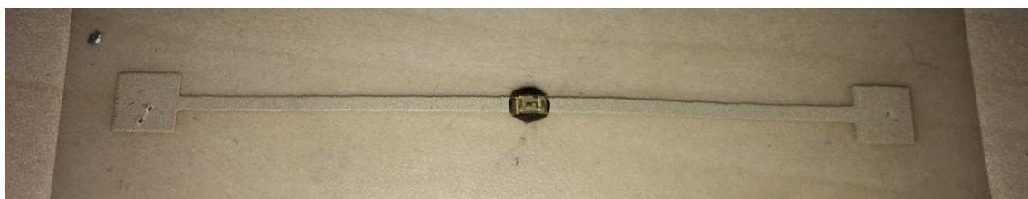
Figura 100. Resultado obtenido con un LED tamaño 1206 tras el uso del adhesivo fluido.
