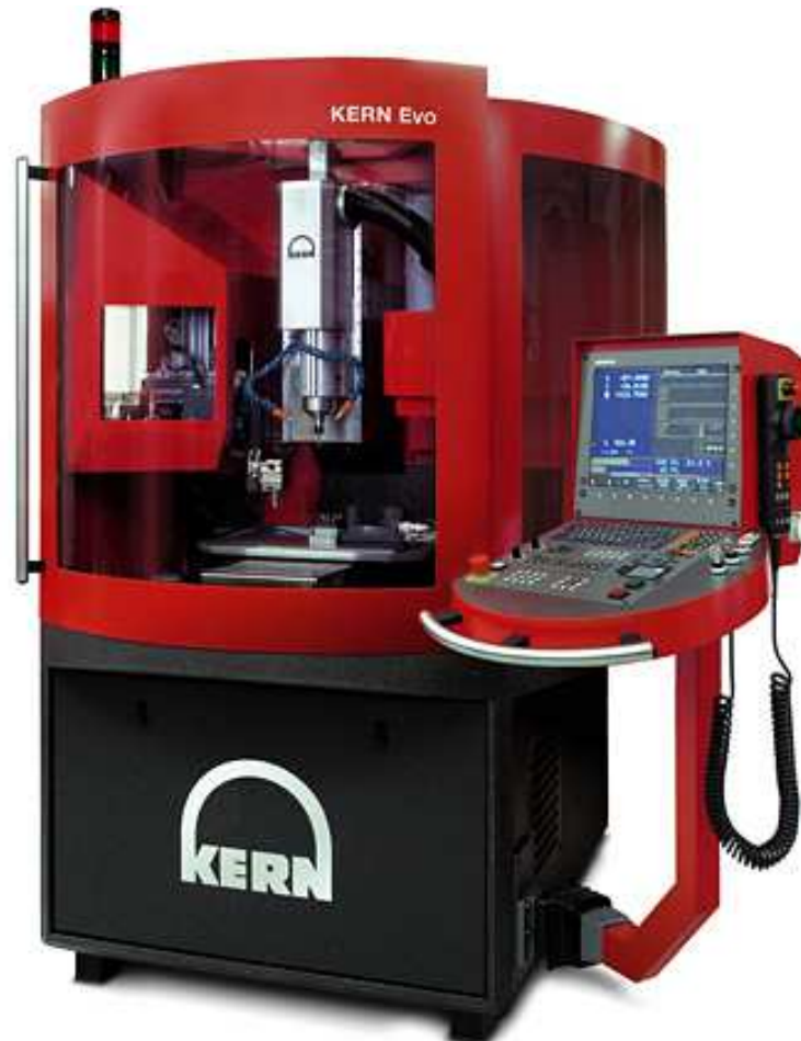
Figura 57. Fresadora CNC empleada para el mecanizado de las piezas del equipo, modelo KERN EVO.
