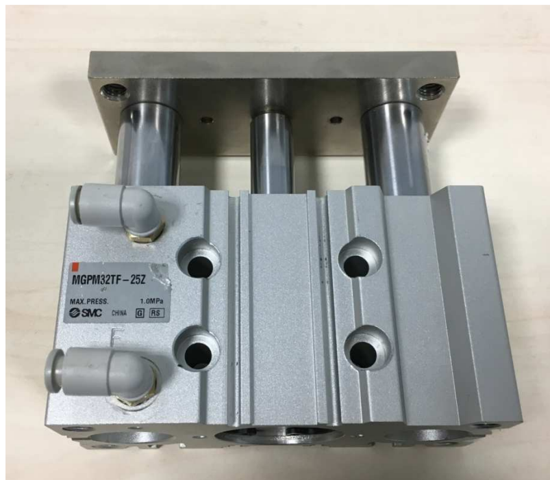
Figura 29. Foto del cilindro seleccionado para el módulo neumático en el desarrollo del equipo.
