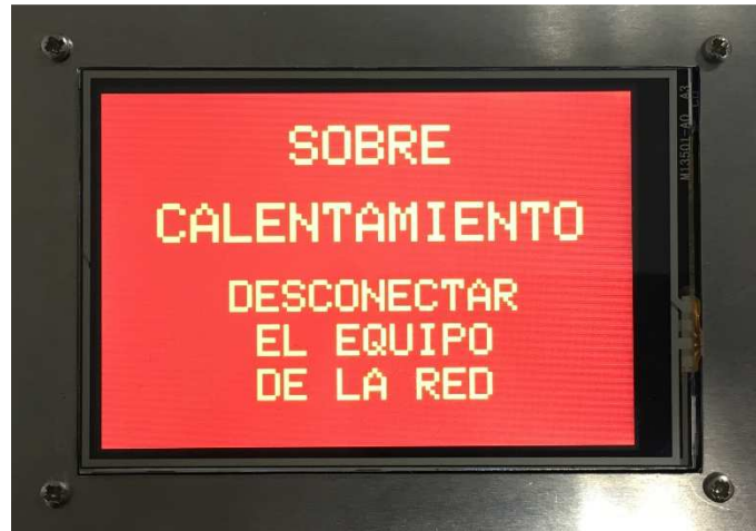
Figura 45. Mensaje de error en el caso de la detección de un sobrecalentamiento del thermode .
