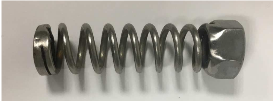
Figura 25. Muelle seleccionado tras haber soldado la tuerca de ajuste.
