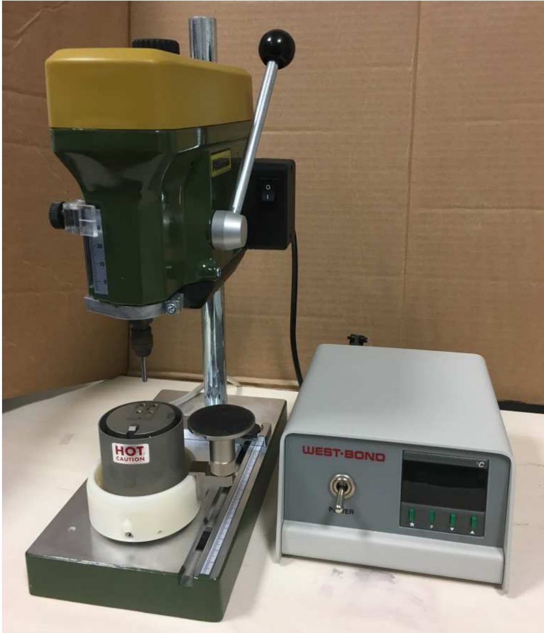
Figura 93. Configuración utilizada para fijar el integrado del sensor utilizando cinta anisotrópica.
