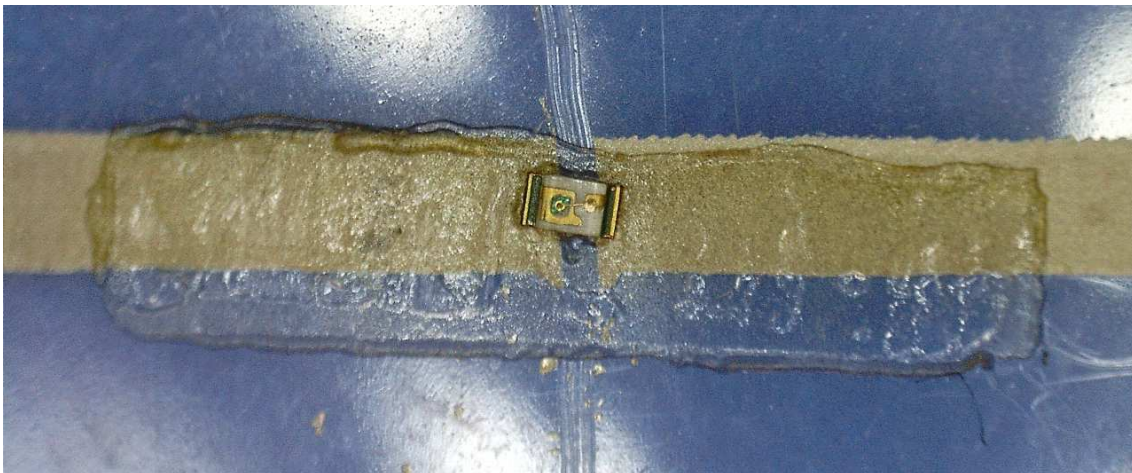
Figura 89. Imagen tomada con un cámara microscopio tras fijar un LED 0603 con la cinta anisotrópica.
