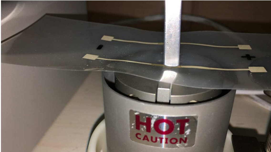
Figura 86. Proceso manual para fijar el LED sobre el circuito utilizando la barra de sección cuadrada.
