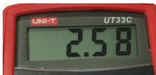
Figura 108. Corriente consumida por la resistencia calefactora.
