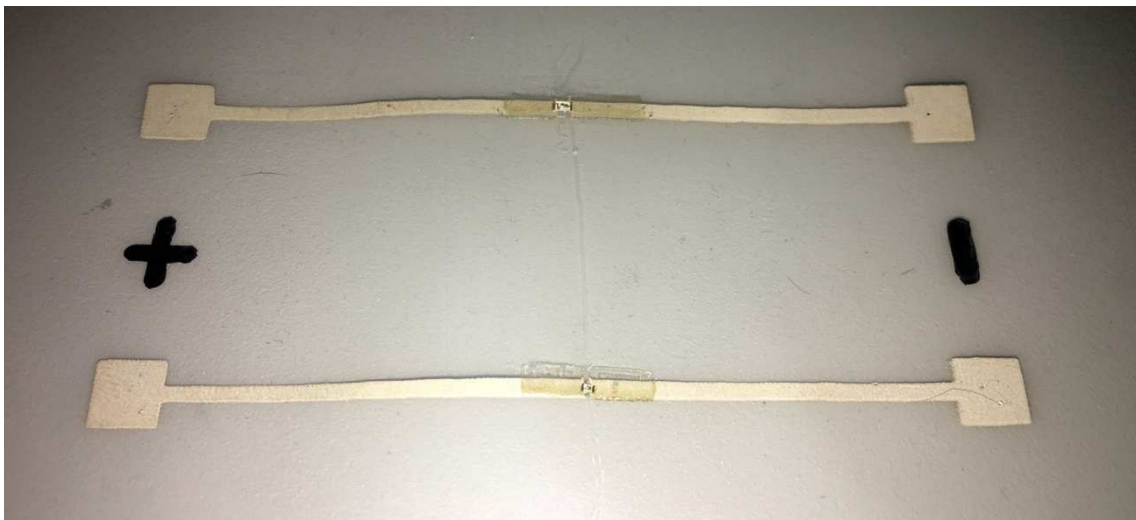
Figura 87. Resultado tras el proceso de conexión de dos LEDs de tamaños 0805 y 0603.
