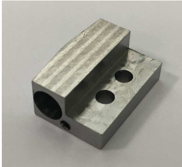
Figura 64. Foto de la pieza mecanizada para fijar la resistencia calefactora al thermode .
