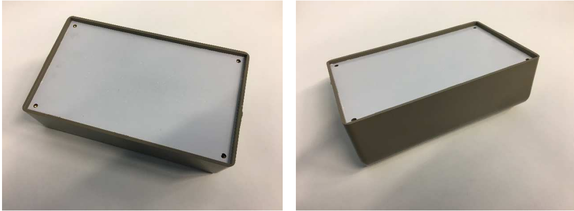
Figura 71. Envoltura seleccionada para montar la parte electrónica del equipo.
