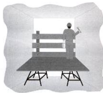
Fig. 16. Andamio protegido junto a abertura en pared.
