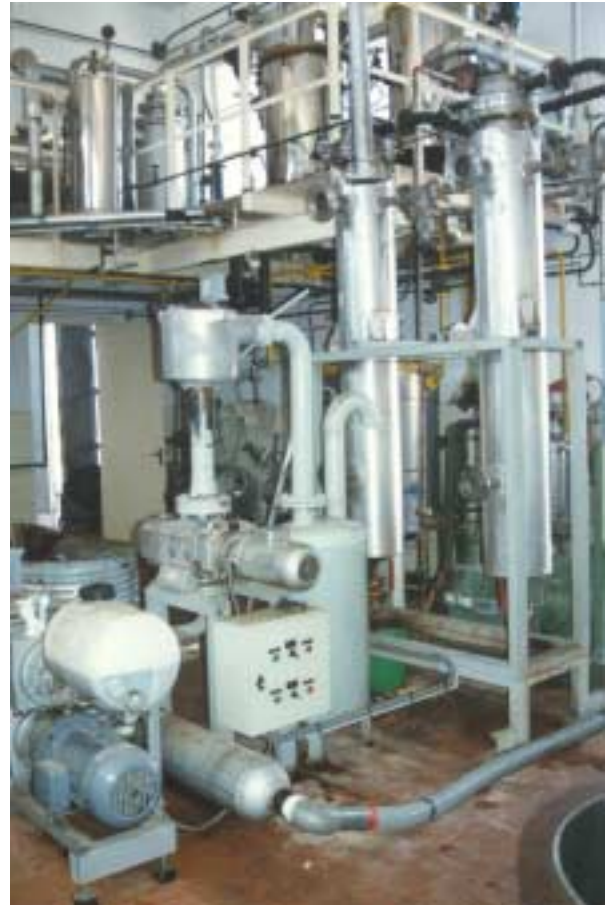
Figura 6. Planta de desodorización instalada en el Instituto de la Grasa de Sevilla
