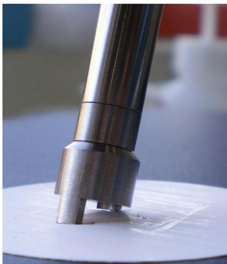
**Figura 28.** Sistema de fibra óptica para la medida de la luminiscencia de la membrana de PTFE con los QDs y TBPE inmovilizados
