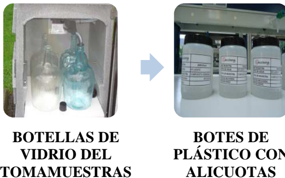
Fotografía 2. Envases utilizados parámetros físico-químicos y fármacos.
