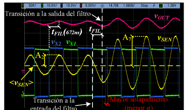
Fig.8. Detalle de una transición en la amplitud de la tensión de salida.
