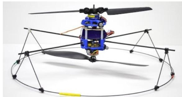
Figura 5 Coaxial copter con mecanismo de acción único [8]
