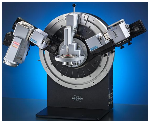
Figura 112 Avance D8 con DAVINCI con detector LYNXEYE.
