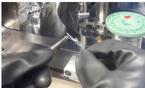
Figura 2 Alambre de aluminio cuelgan del filamento en la cámara de deposición.
