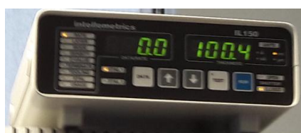
Figura 44 Monitor para controlar el espesor de la película.
