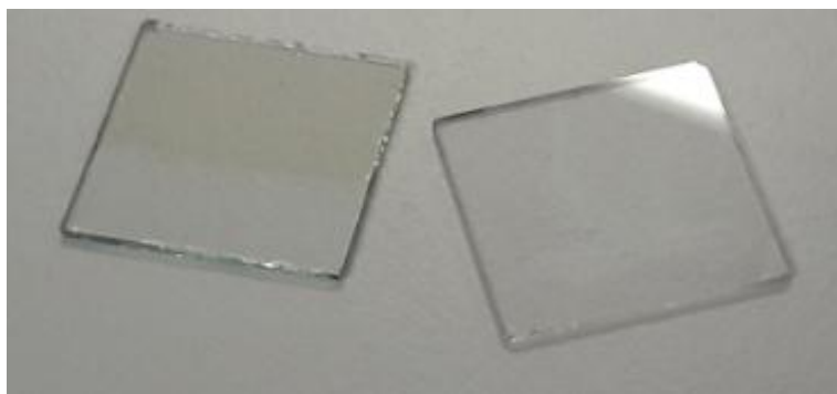
Figura 1 Substrato de vidrio recubierto con ITO pre-estampado.
