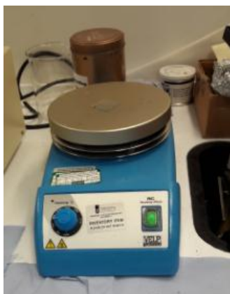
Figura 10 Placa calefactora para el secado del PEDOT. PSS.
