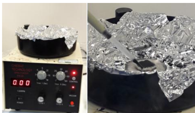
Figura 9 Caída del PEDOT: PSS en toda la sección del sustrato.
