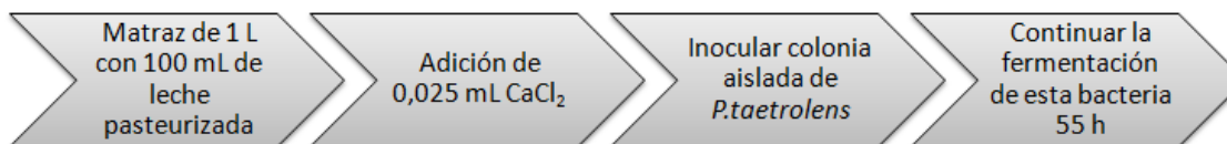
Figura 12. Diagrama de flujo de la fermentación con \text{CaCl}_2 en agitador orbital a nivel de matraz.
