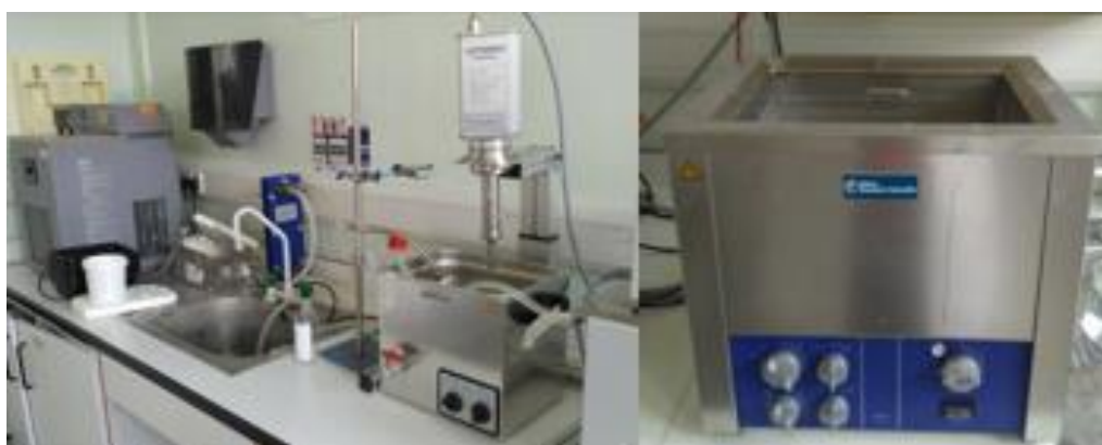
Figura 6. Equipos de ultrasonidos. Sonda de ultrasonidos (izquierda) y baño de ultrasonidos (derecha).
