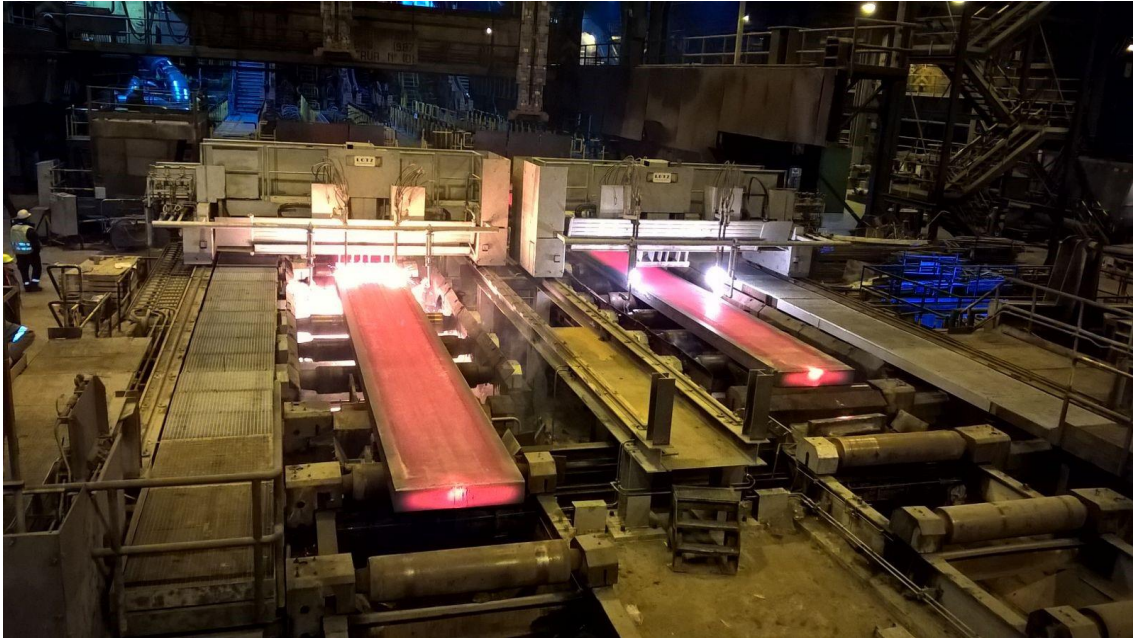
FIGURA 4: MÁQUINAS DE COLADA CONTINUA EN LA ACERÍA DE ARCELOR MITTAL EN AVILÉS.
