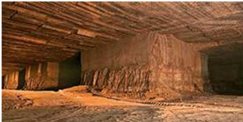
Fig. 3-17 Explotación mediante cámaras y pilares.
