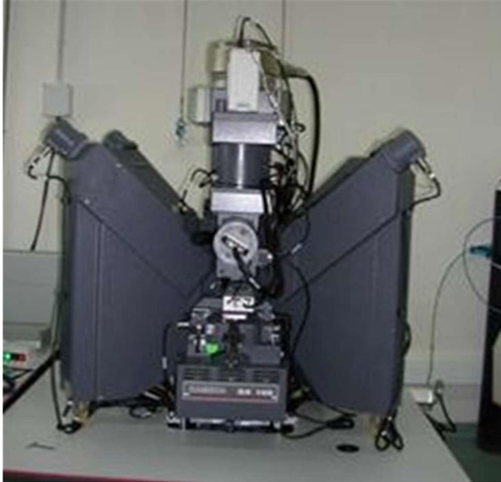
**Figura 26. Microsonda electrónica modelo CAMEBAX SX-100 (Universidad de Oviedo).**
