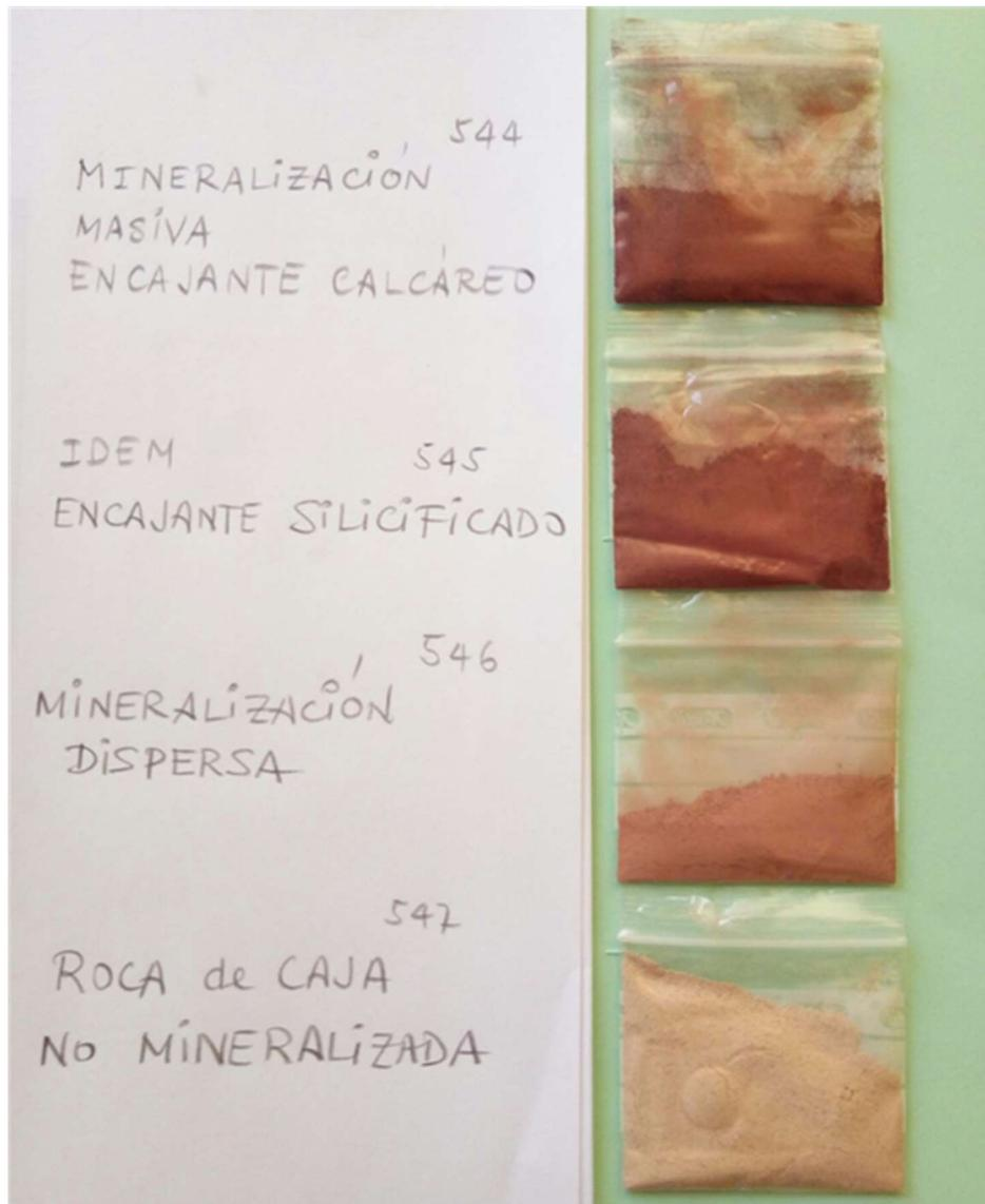
**Figura 29. Aspecto de las muestras medidas mediante FRX. Nótese que la ley va en función de la tonalidad rojiza, más marcada para las más ricas.**
