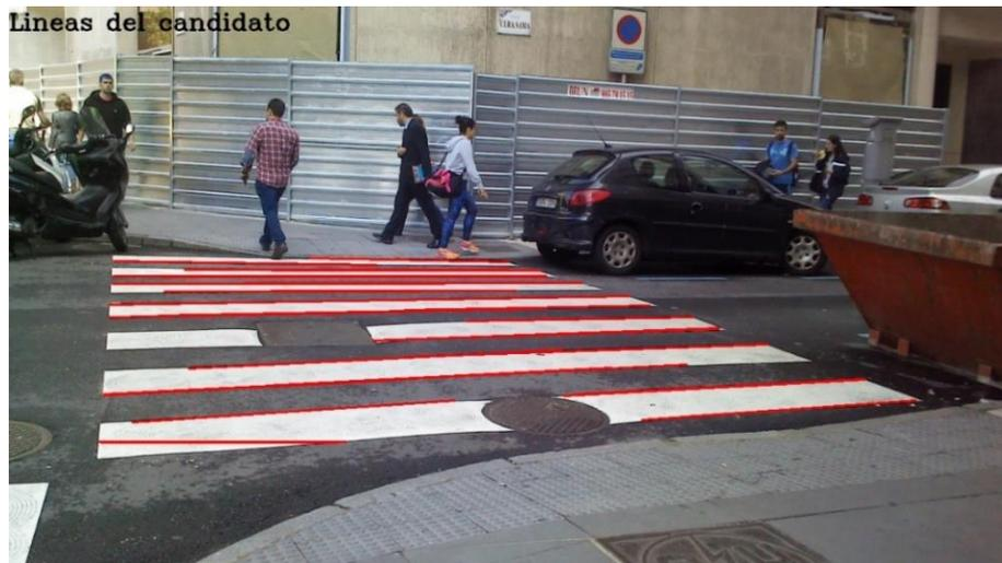
Figura 3.5. Rectas detectadas en el candidato mediante la transformada de Hough probabilística.
