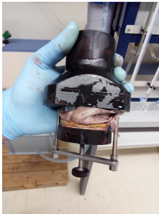
Figura 28.- Muestra colocada en el soporte del permeámetro.
