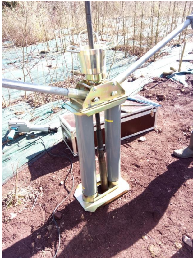
Figura 25.- Mecanismo empleado para extraer la barrena del suelo.
