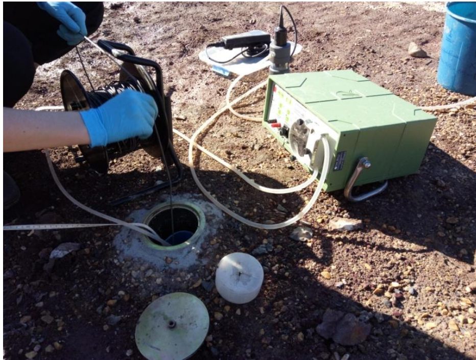
Figura 34.- Bombeo de agua con la bomba peristáltica mientras se mide el nivel piezométrico.
