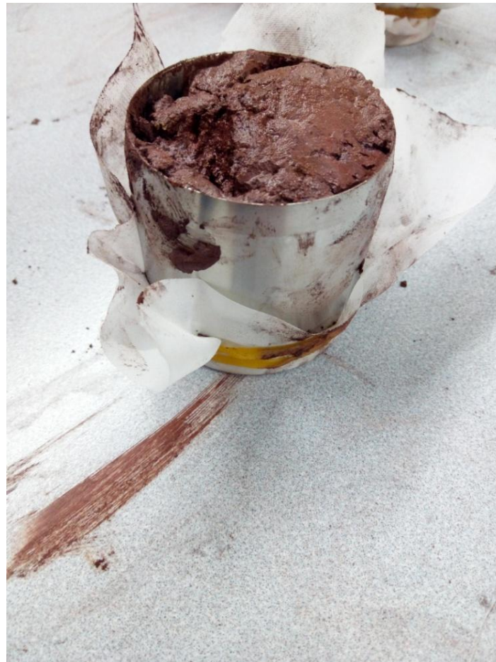
Figura 26.- Muestra para ensayo de permeabilidad preparada, con el papel de filtro colocado.
