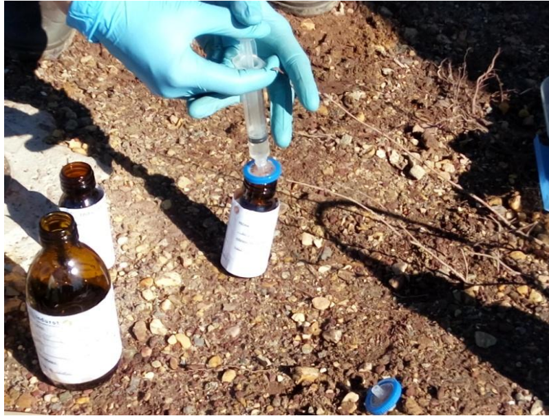
Figura 36.- Relleno con filtro y jeringuilla de una botella de muestra.
