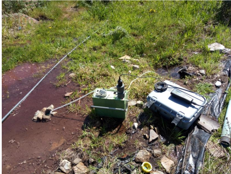
Figura 43.- Distribución de los instrumentos en el ensayo de inundación.
