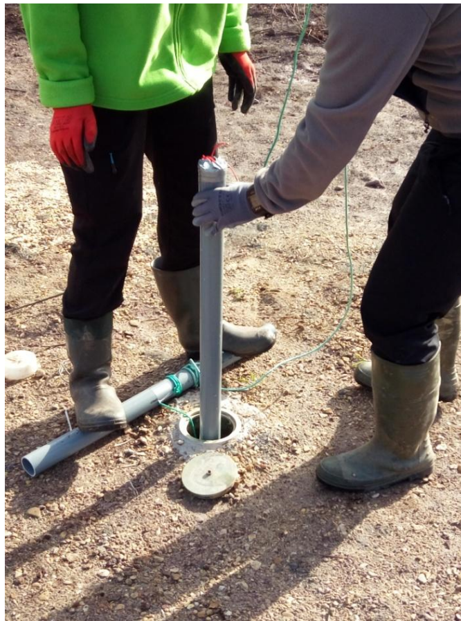
Figura 22.- Barra (slag) que se introduce en los sondeos para realizar el ensayo.
