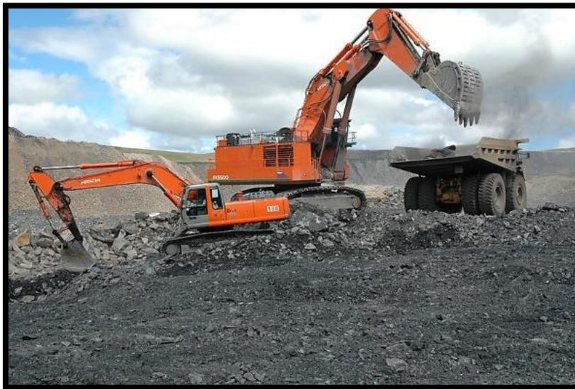
*Figura 30 Excavadoras cargando un volquete en la Gran Corta de Fabero*
