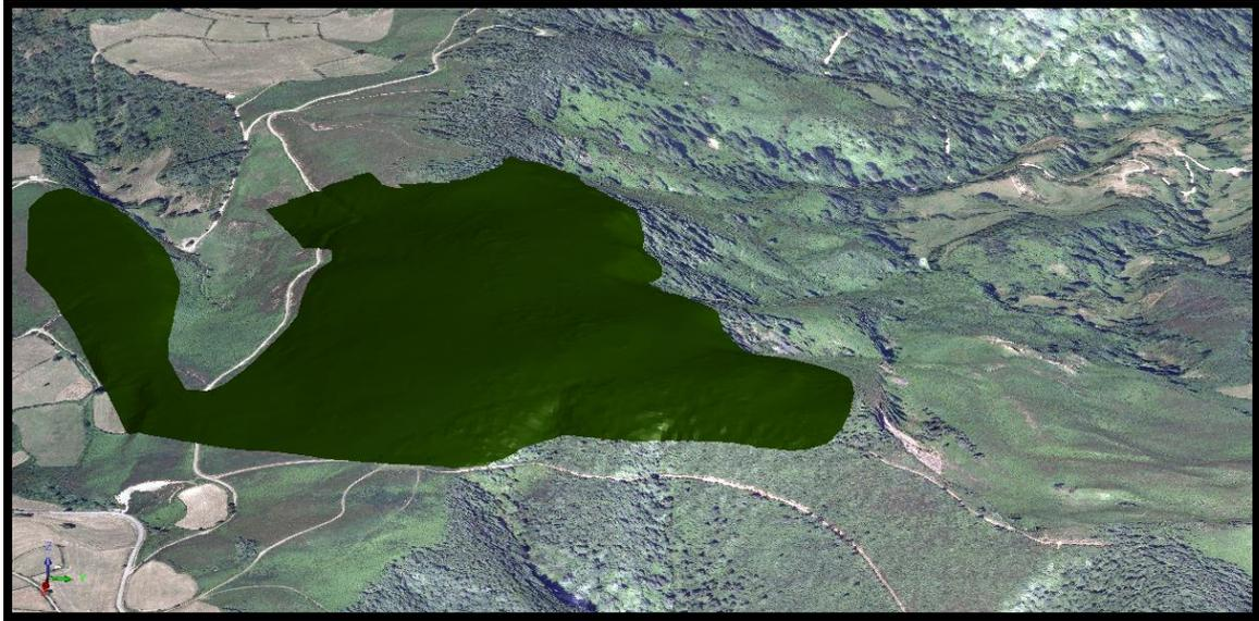
*Figura 42 Modelización del relleno total de la explotación (verde oscuro)*
