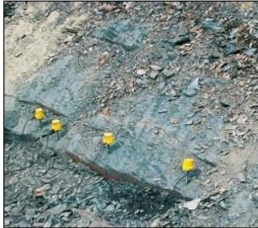
Figura 25 Medición in situ de la velocidad sísmica (Fotografía de CARBONAR)
