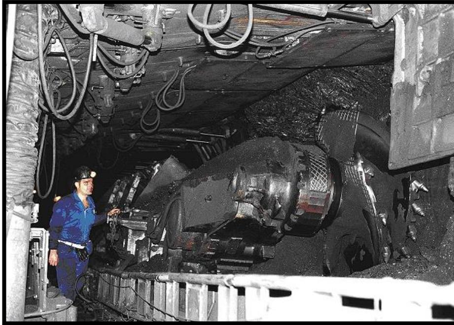
*Figura 15 Rozadora con estibación autodesplazable trabajando en Carbonar (Fotografía de CARBONAR)*
