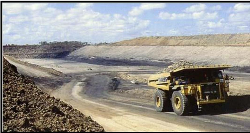
*Figura 23 Transporte mediante volquetes en una corta de carbón*
