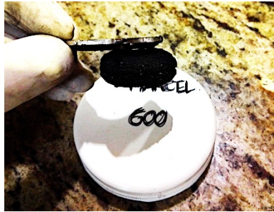
Figura 8.2.- Briqueta de la serie BMR carbonizada a 600 °C atraída por el campo de magnético de un imán.
