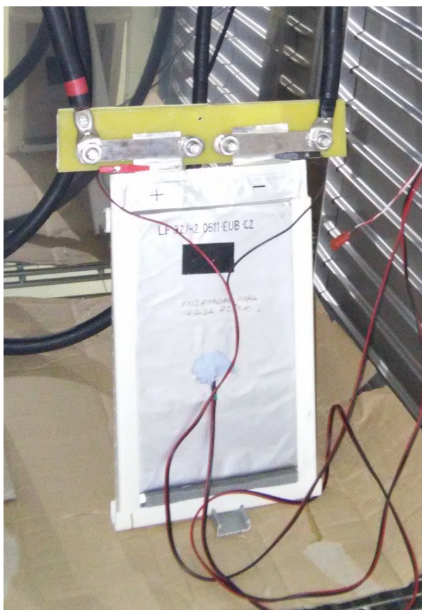
FIGURA 4.1: Celda de \text{LiFePO}_4 de European Batteries ensayada para el presente estudio.
