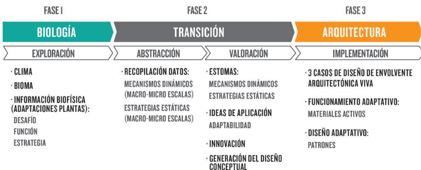
Figura 6.56 Diagrama de flujo de la metodología “De las plantas a la arquitectura”
