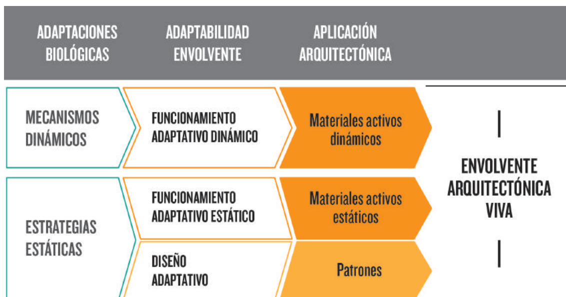
Figura 3.27 Diagrama de la adaptabilidad en la envolvente.
