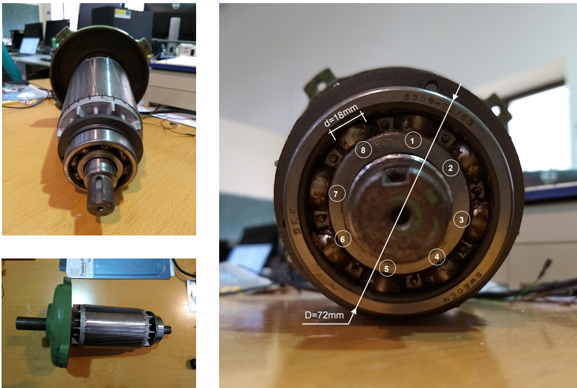
Figura 3.22. Motor sometido a los ensayos dataicann.
