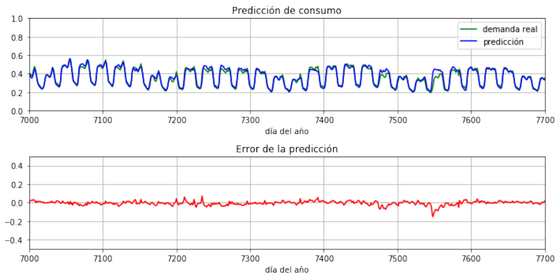
Figura 3.13. Predicción de consumo con arquitectura LSTM.
