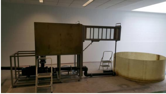
Figura 1(b): Túnel de agua instalado
