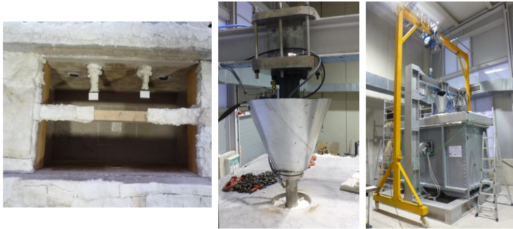
Figura 3 a) Montaje de la estructura de madera. b) Cilindro de carga. c) Montaje completo en el horno de ensayos (Universidad de Oviedo, GICONSIME Research Group).
