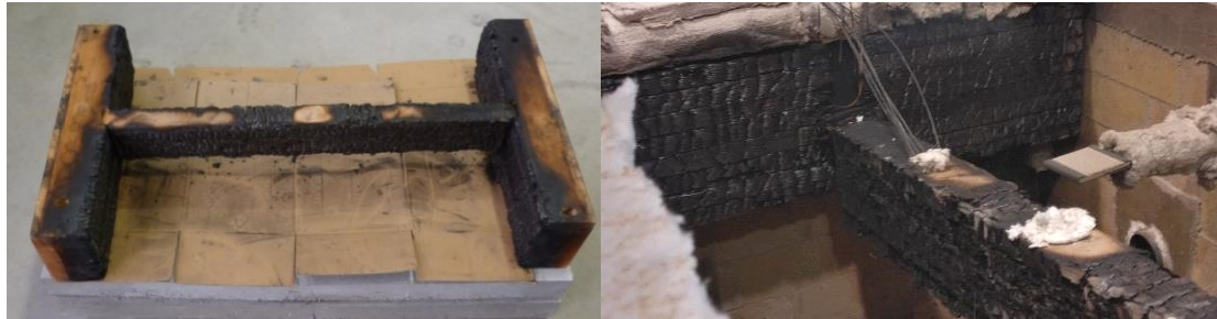
Figura 5 a) Vista del conjunto tras el ensayo y b) detalle del fallo en la cola de milano.
