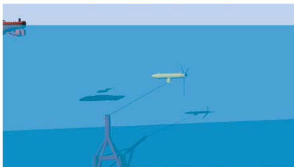
Figura 3: Ejemplo de maniobra de inmersión automatizada con control de agua de lastre
