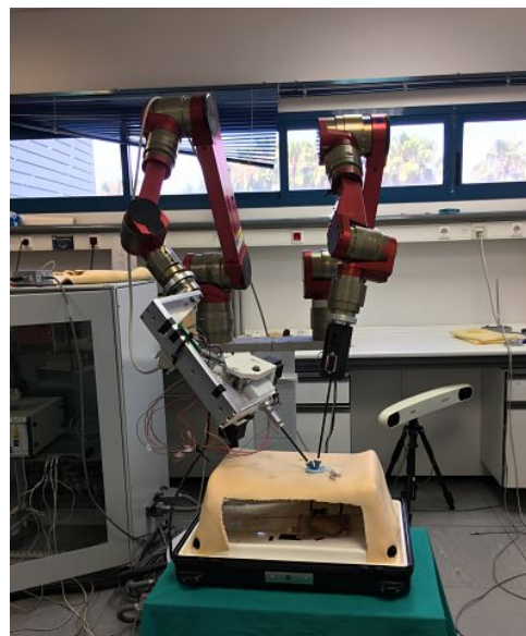
Figura 7: Plataforma CISOBOT dotada del instrumento motorizado.
