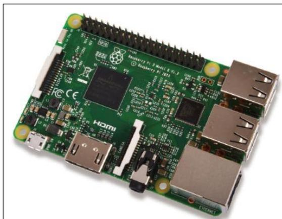
Figura 48. Raspberry Pi 3 modelo B
