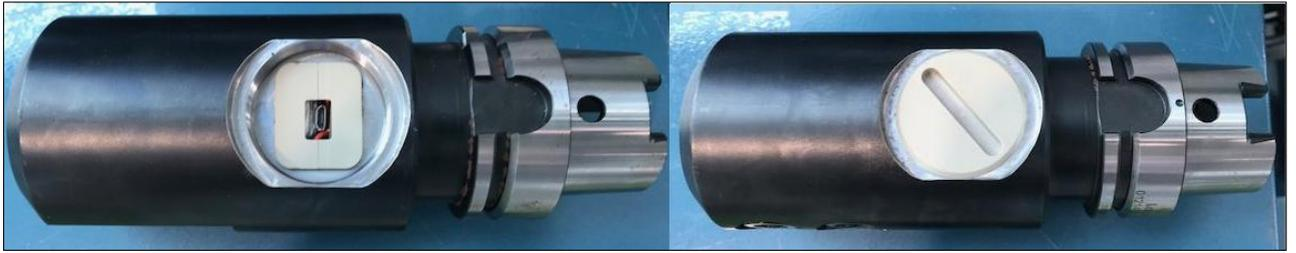
**Figura 44. Portaherramientas con dispositivo de medición de vibraciones**
