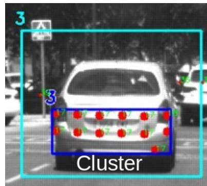
Figura 5: Detección de obstáculo basado en cálculo de cluster. Rectángulo azul oscuro es el cluster, rectángulo azul claro es la ROI para VC
