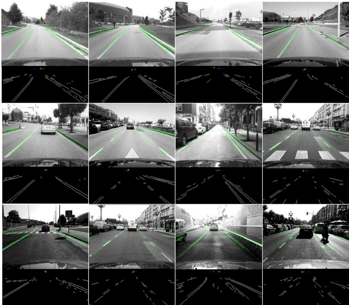
Figura 8. Ejemplos de la estimación de los puntos de fuga en diferentes tipos de vía urbana y diferentes condiciones de iluminación. En la imagen superior de cada ejemplo se muestra la imagen original con los potenciales bordes de carril y límites de vía sobreimpresionados en verde, mientras que en la imagen inferior se muestran dichos bordes en la ROI. En ambas imágenes se muestran los puntos de fuga estimados de los tres tramos.
