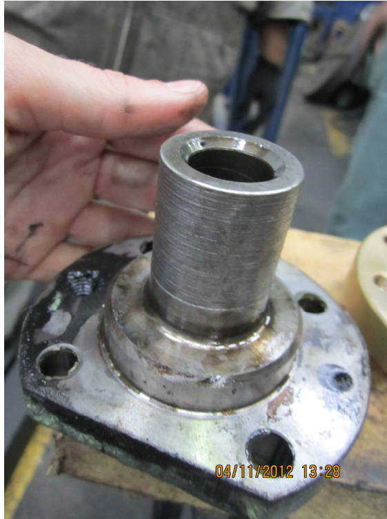
Imagen 19. Distribuidor E125.00 dañado. Fuente [2]
