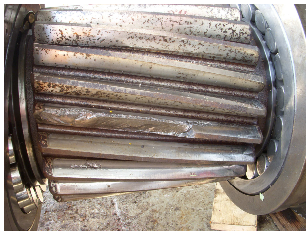
Imagen 17. Conjunto eje entrada. Rotura diente eje piñón R101.00. Fuente [2]
