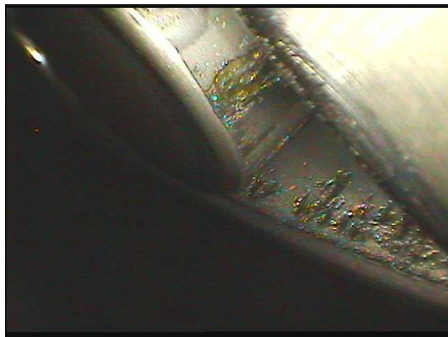
Imagen 13. Vista interior del rodillo y pista cojinete. Fuente [2]
