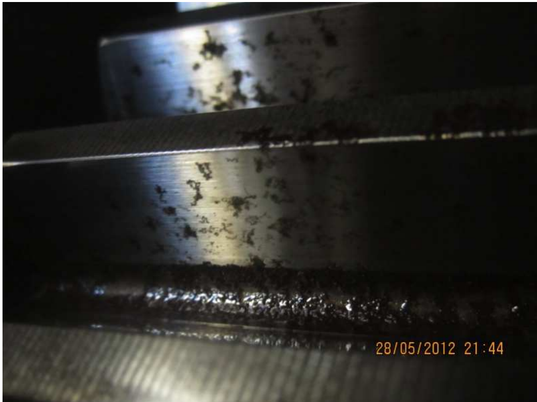
Imagen 12. Superficie en los dientes de la rueda dentada eje de entrada transmisora de movimiento al eje de la PTO. Fuente [2]
