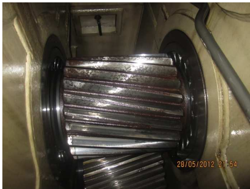
Imagen 7. Marcas de oxidación. Fuente [2]
