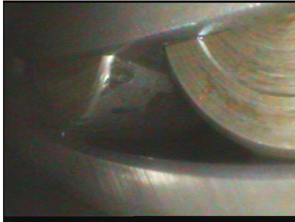
Imagen 14. Vista interior del rodillo y pista cojinete. Fuente [2]
