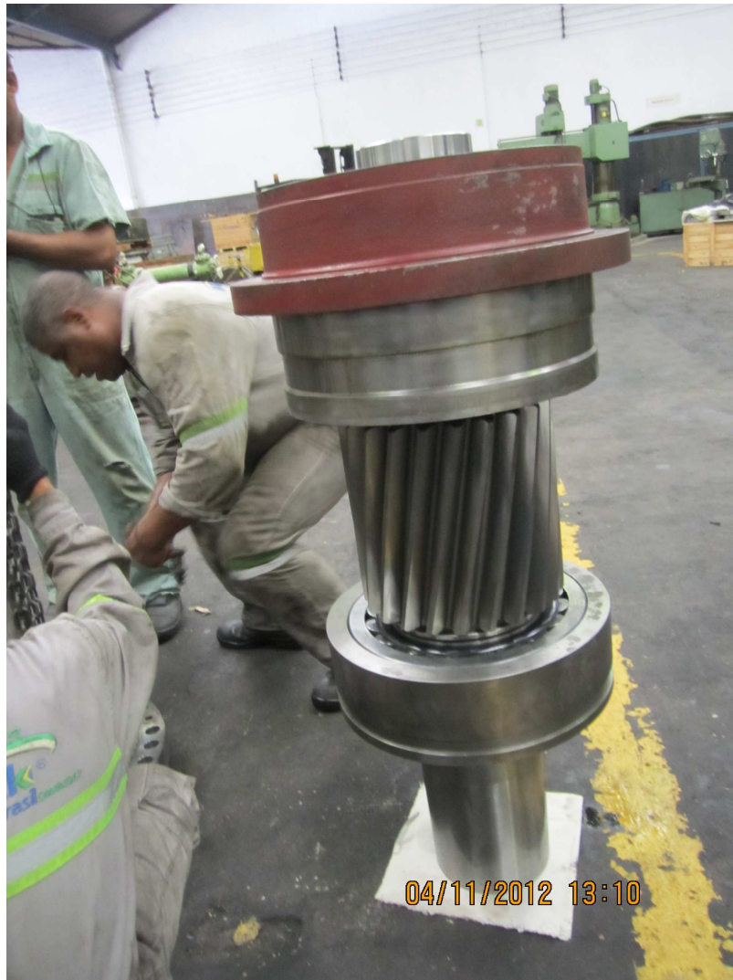
Imagen 18. Eje piñón reparado. Fuente [2]
