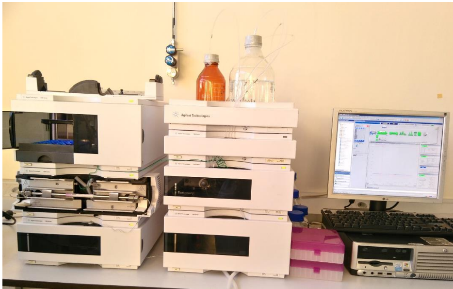
Fig. 13. Módulos del equipo de Agilent Technologies 1200 Series HPLC.
