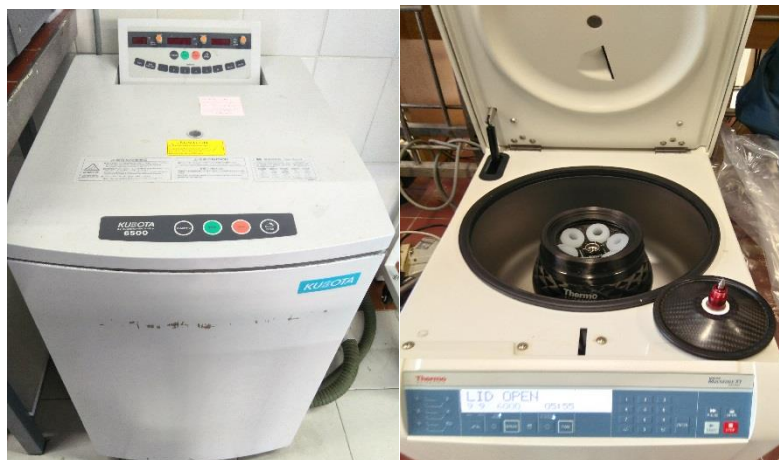
Fig. 6. Centrífuga de KUBOTA (izquierda) y centrífuga de Thermo Scientific (derecha).
