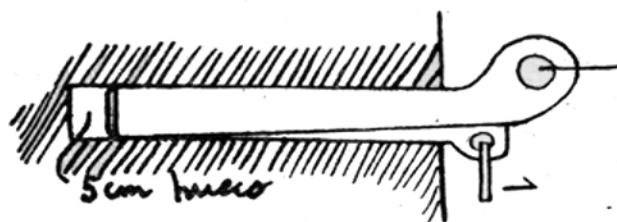
Fig. 19.—Tipo de grapa de seguridad insacable al tiro
