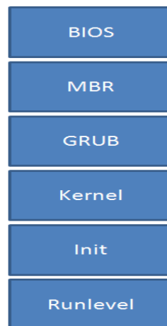
Ilustración 52 Linux "Boot Process". Fuente: Elaboración propia.
