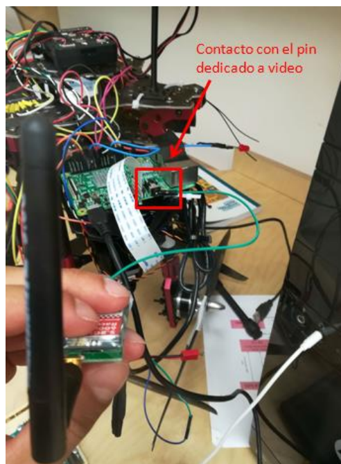
Ilustración 170 Contacto entre el pin dedicado a video en el Jack TRRS de la Raspberry y la Tx. Fuente: Elaboración propia.
