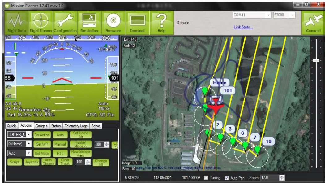
Ilustración 26 Seguimiento de una misión de vuelo desde la estación de tierra usando el software "Mission Planner". Acceso: 24/4/2018.Fuente: https://www.google.es
