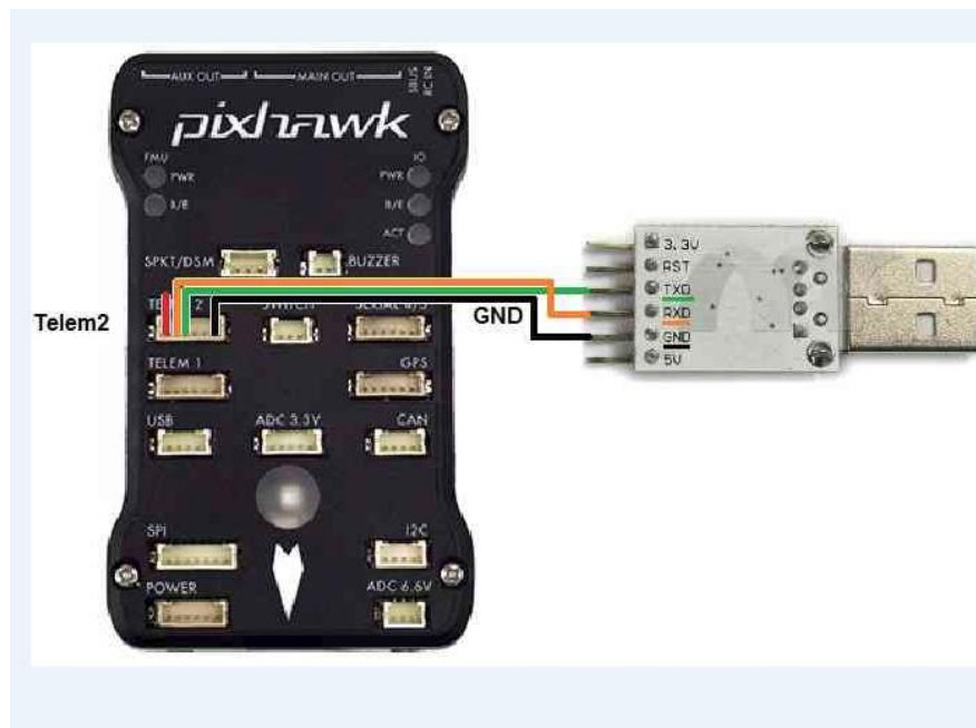
Ilustración 47 Conexión controladora Raspberry vía USB. Fuente: https://vueloartificial.com/1-conexion-vuelo-controlado-mediante-raspberry-pi/
