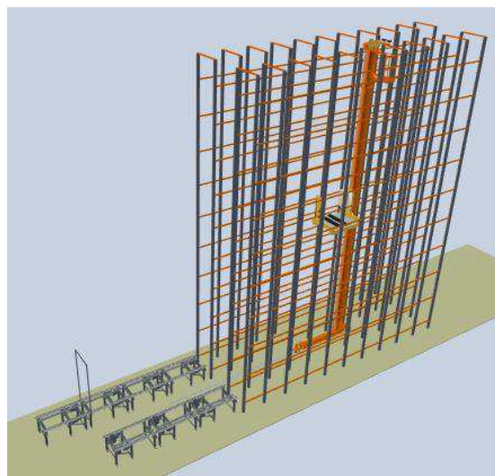
Figura 1.3.- Ejemplo de instalación simulada con un transelevador.
