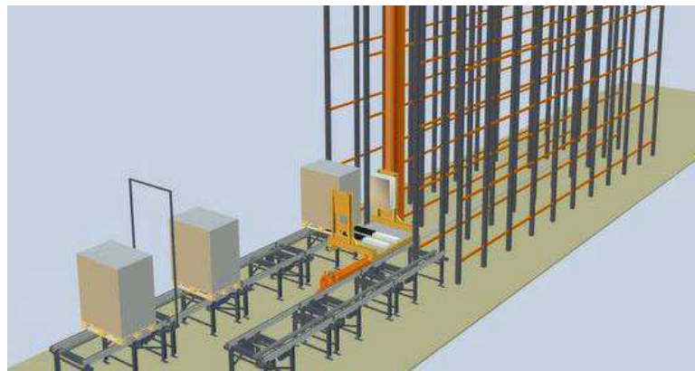
Figura 6.6.- Recogida de contenedor de ME mediante transelevador
