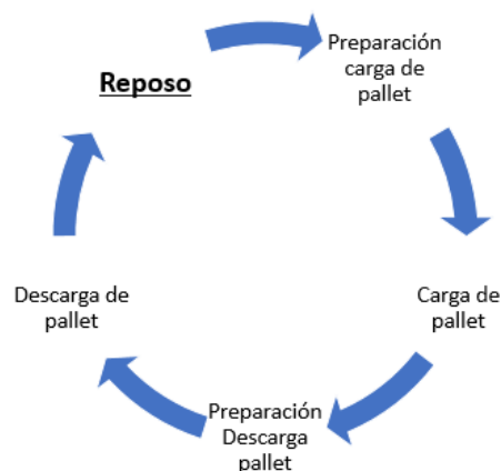
Figura 4.2.- Modo de funcionamiento automático del traslo
