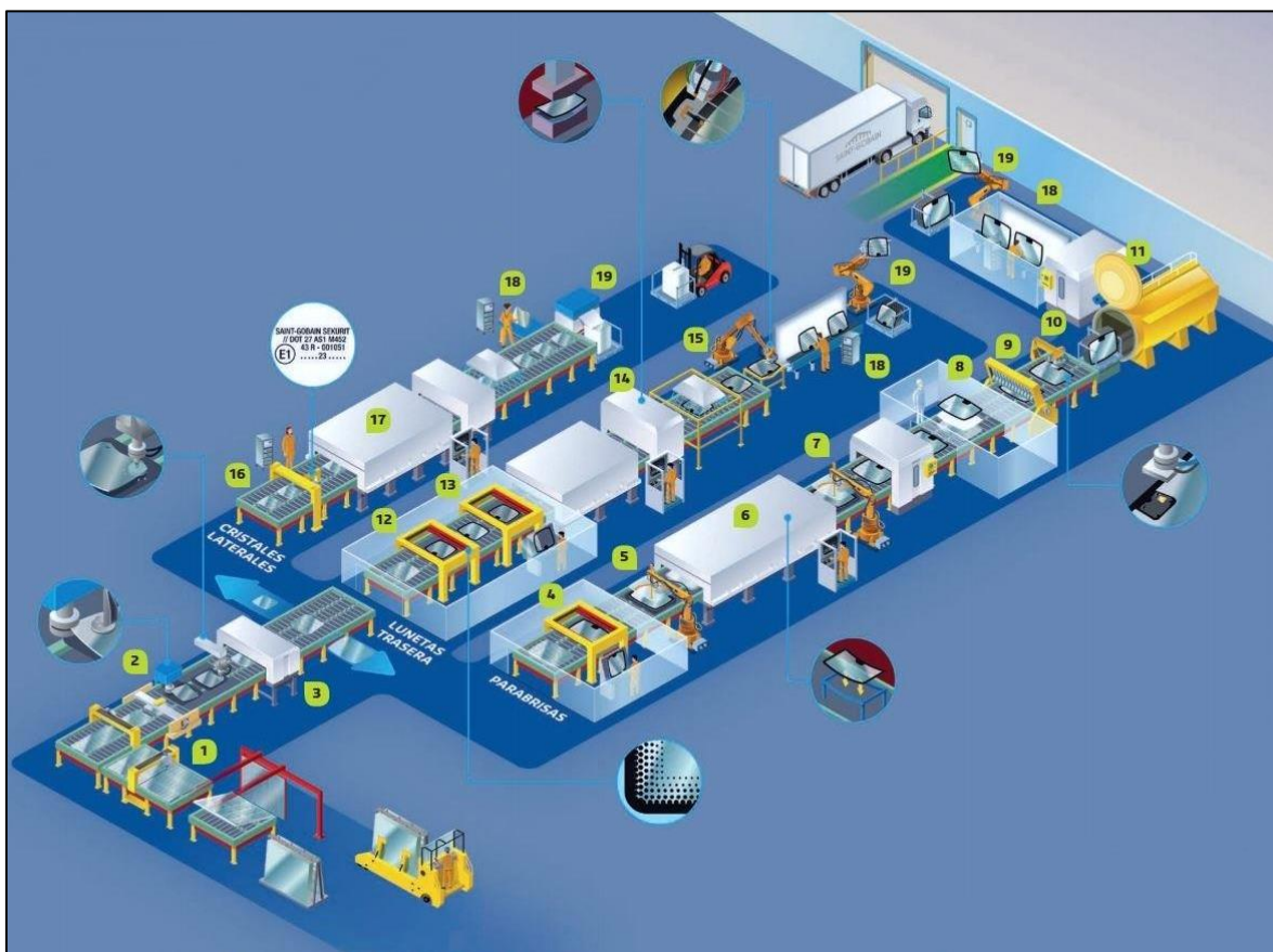
Figura 2.5. Proceso de fabricación de acristalamiento para automóviles [6]
