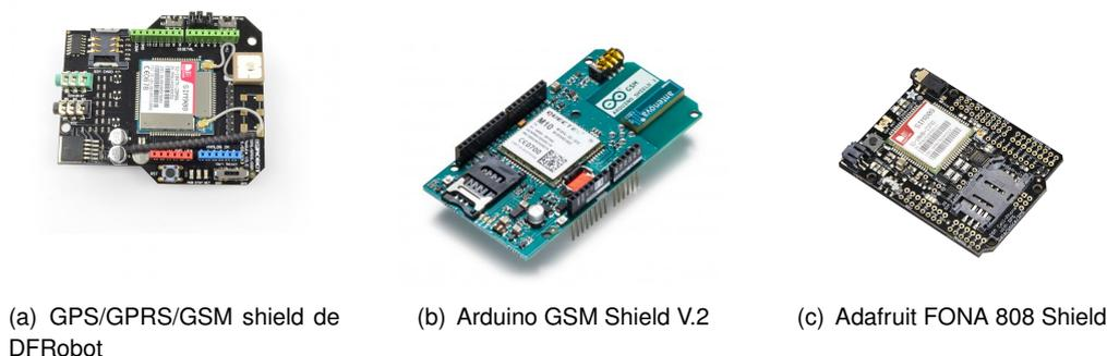
**Figura 6.2.0.1** – Módulos GPS-GPRS-GSM para Arduino.
