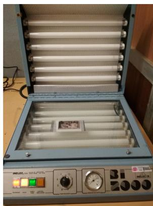
**Figura 4.4.0.1** – Placa de acople introducida en la insoladora
