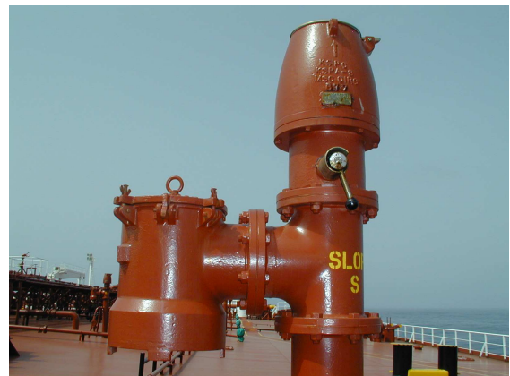
Imagen 3.- Válvula P/V presión vacío
