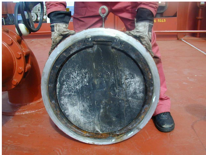
Imagen 5.- Válvula de no retorno de Gas Inerte
