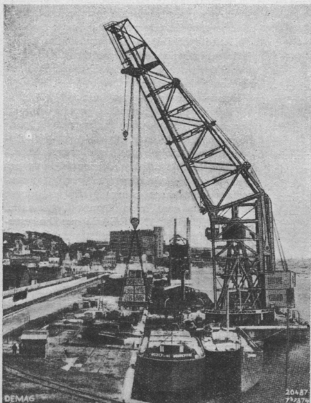
Grúa flotante con brazo basculante de 150 tds. de potencia, provista de accionamiento Diesel-eléctrico. Construída para el puerto de Marsella, por la casa Demag.
