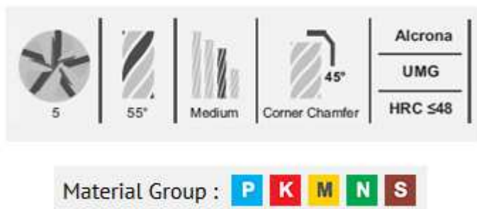
Figura 3.4- Características de la fresa y materiales aptos.
