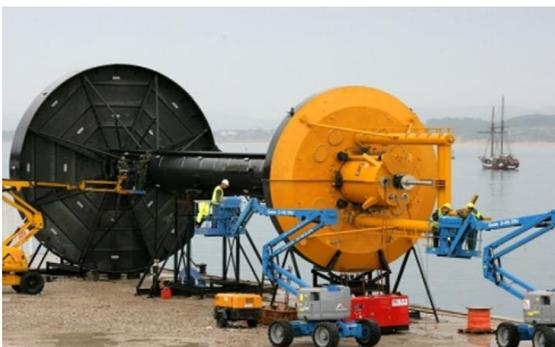
*Ilustración 30 El prototipo de PowerBuoy desplegado en Santoña, España, en 2008 [6]*
