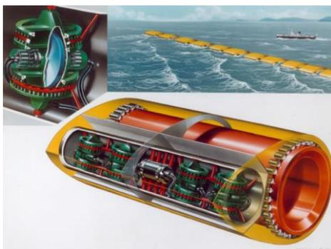
Ilustración 38 La versión del Duck de 1979 equipada con giroscopios [6]
