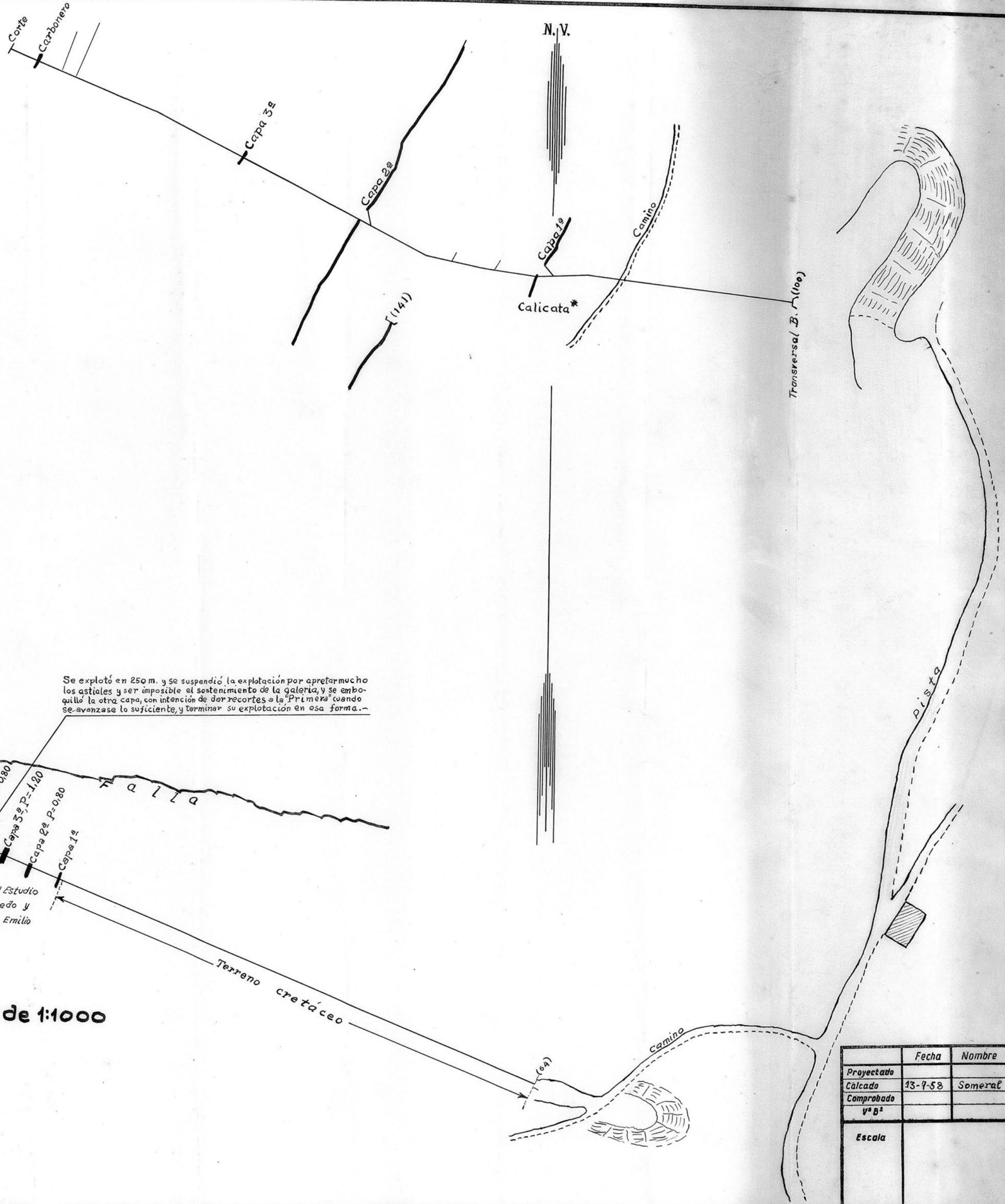
Se explotó en 250 m. y se suspendió la explotación por apretarmucho los astiles y ser imposible el sostenimiento de la galería, y se embocilló la otra capa, con intención de dar recortes a la "Primera" cuando se avanzase lo suficiente, y terminar su explotación en esa forma.
