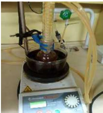
Figura 1AI. Calentamiento a reflujo en baño de aceite durante la síntesis de las AuNps sobre placa calefactora.
