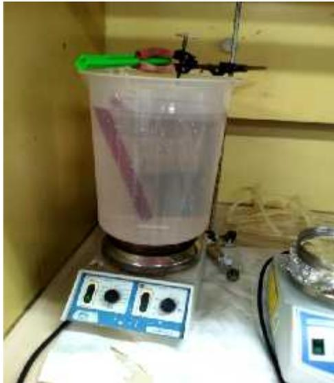
Figura 3AI. Purificación de las AuNps mediante el empleo de una membrana de diálisis.
