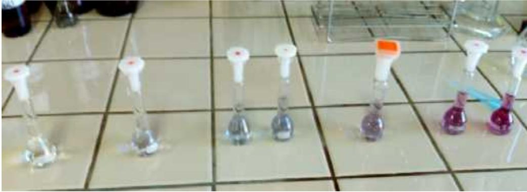
Figura 7AI. Disoluciones de AuNPs con concentraciones crecientes de vitamina B<sub>1</sub>.
