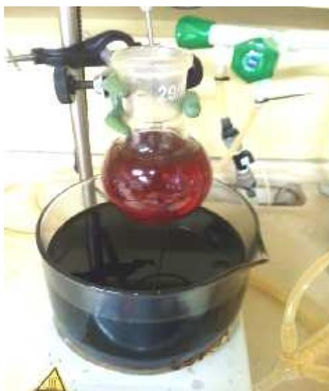
Figura 2AI. Disolución de AuNps obtenida. Obsérvese el característico color rojo.
