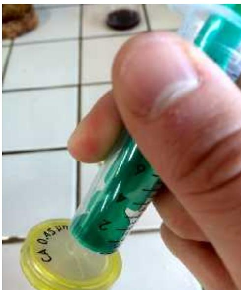
Figura 6AI. Filtro de jeringa de 0,45  $\mu\text{m}$  utilizado para la purificación de los GSH-AuNCs.
