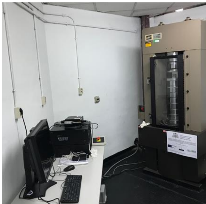
FIGURA 3-11. Prensa y consola de control utilizada en el ensayo resistencia a la compresión simple.
