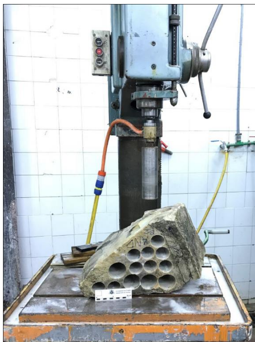
FIGURA 3-4. Máquina “heelt” empleada en la obtención de probetas a partir de los bloques de roca.
