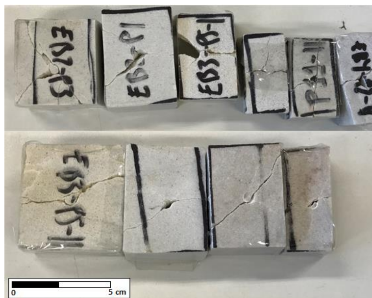
FIGURA 4-21. Tipos de rotura en el ensayo llevado a cabo en bloques.
