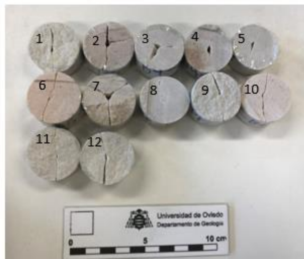
FIGURA 4-19. Tipos de rotura en el ensayo axial.
