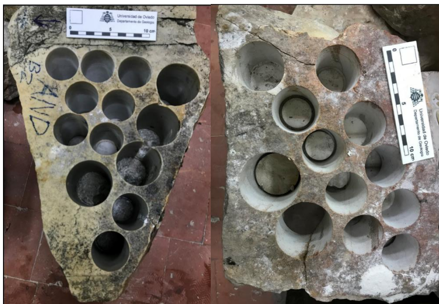
FIGURA 3-6. Ejemplo de la distribución de probetas en los bloques 1 y 2 (derecha e izquierda, respectivamente).
