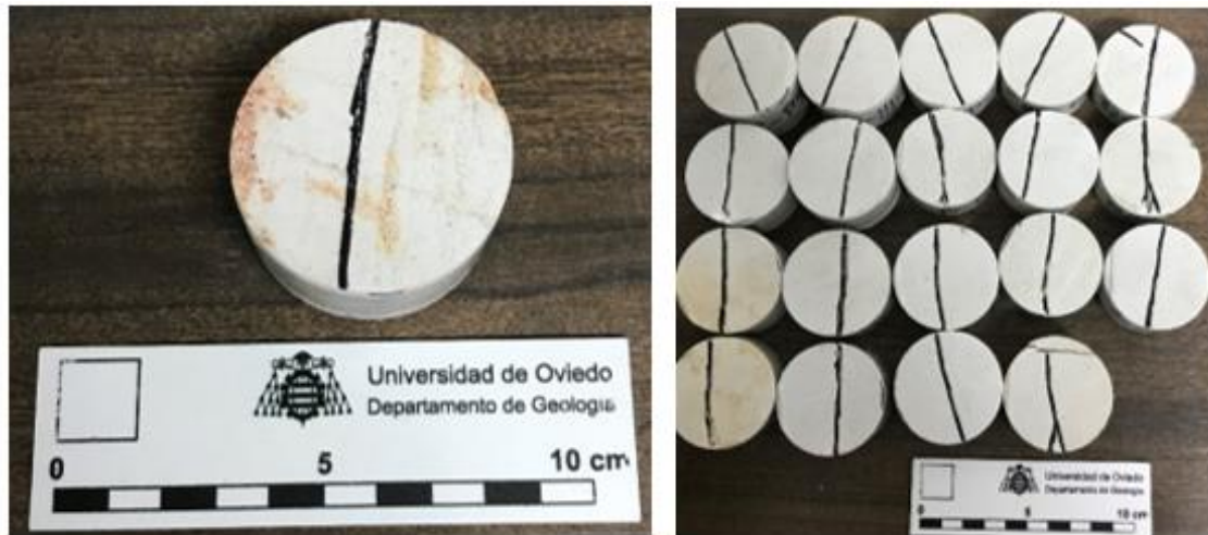
FIGURA 4-16. Tipo de rotura del ensayo brasileño. Muestra del bloque 1 (izquierda); muestras bloque 2 (derecha).
