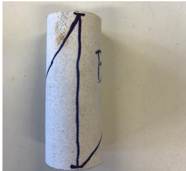
FIGURA 3-8. Probeta de 35 mm, marcada para observar la rotura en el ensayo de resistencia a compresión uniaxial.
