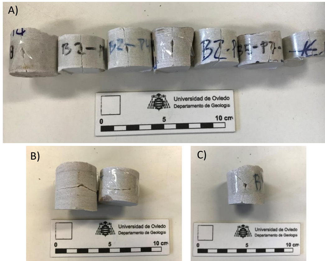
FIGURA 4-20. Tipos de rotura en el ensayo diametral. A: punto triple; B y C: verticales.
