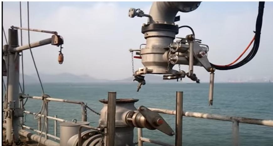
*Ilustración 28: Demostración del cierre de seguridad en los brazos de la terminal.*
