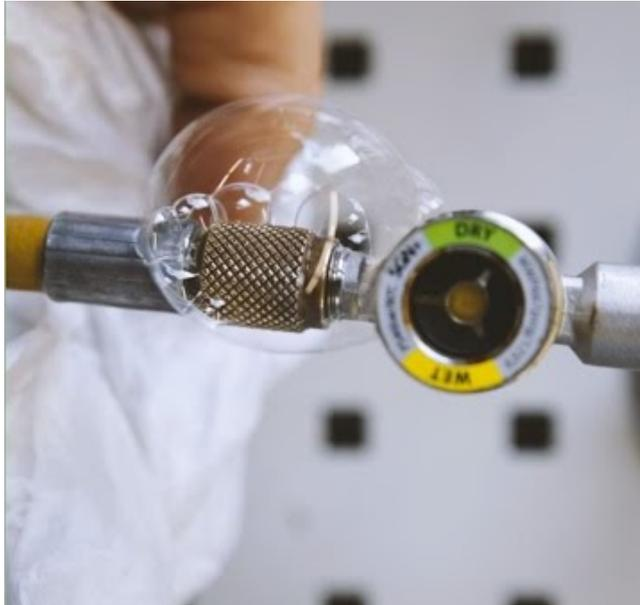
*Ilustración 39: Prueba de fugas con jabón*
