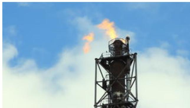
*Ilustración 36: antorcha terminal de LNG.*
