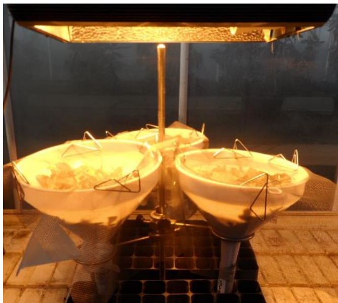
Figura 4.2. Montaje empleado para la extracción de pequeña fauna basado en un sistema tipo Berlese-Tullgren.
