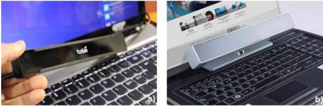
Figura 3.14. Equipos de seguimiento de la pupila a través de luz infrarroja: a) sistema Tobii [70] , b) equipo Irisbond [21] .
