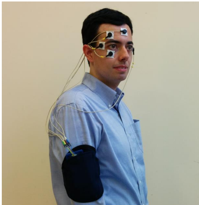
Figura 7.21. El dispositivo hardware desarrollado se sujeta al brazo del usuario y los electrodos se disponen en la cara.
