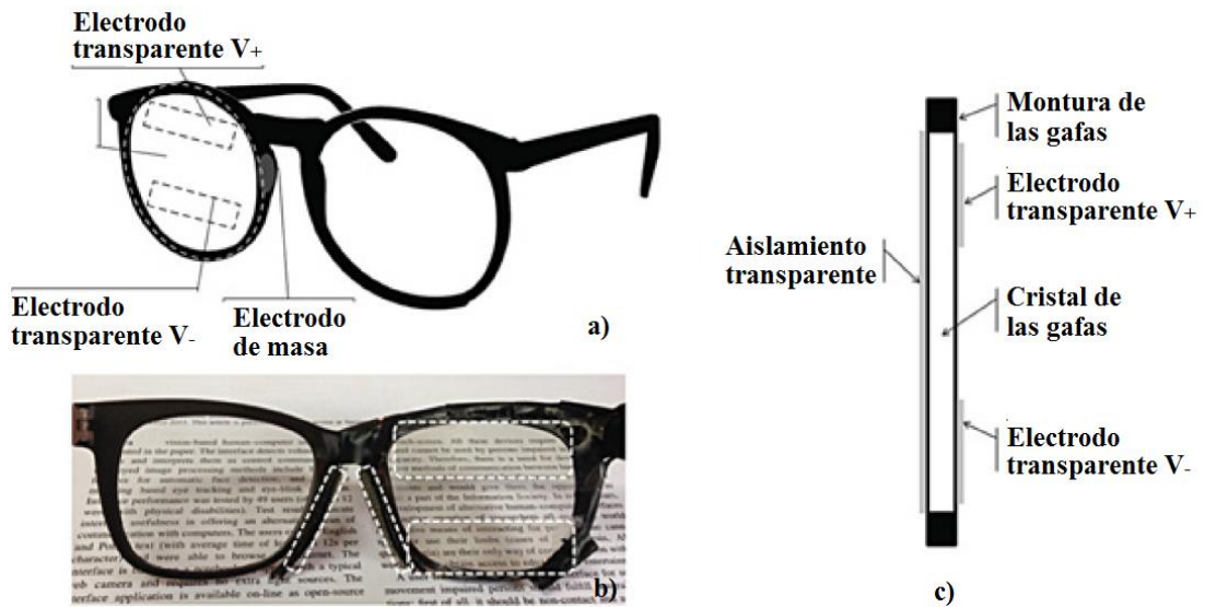
Figura 4.40. Registro de la señal EOG mediante gafas convencionales y electrodos ITO [93] .
