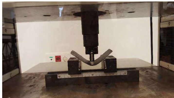
Figura 3 Ensayo de flexión a tres puntos.
