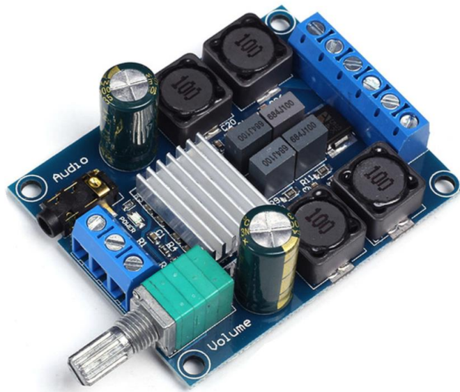
Figura 5.4 Amplificador digital TPA3116D2 utilizado en el sistema desarrollado
