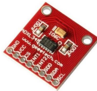
Figura 5.2 Acelerómetro ADXL345 utilizado en el sistema desarrollado
