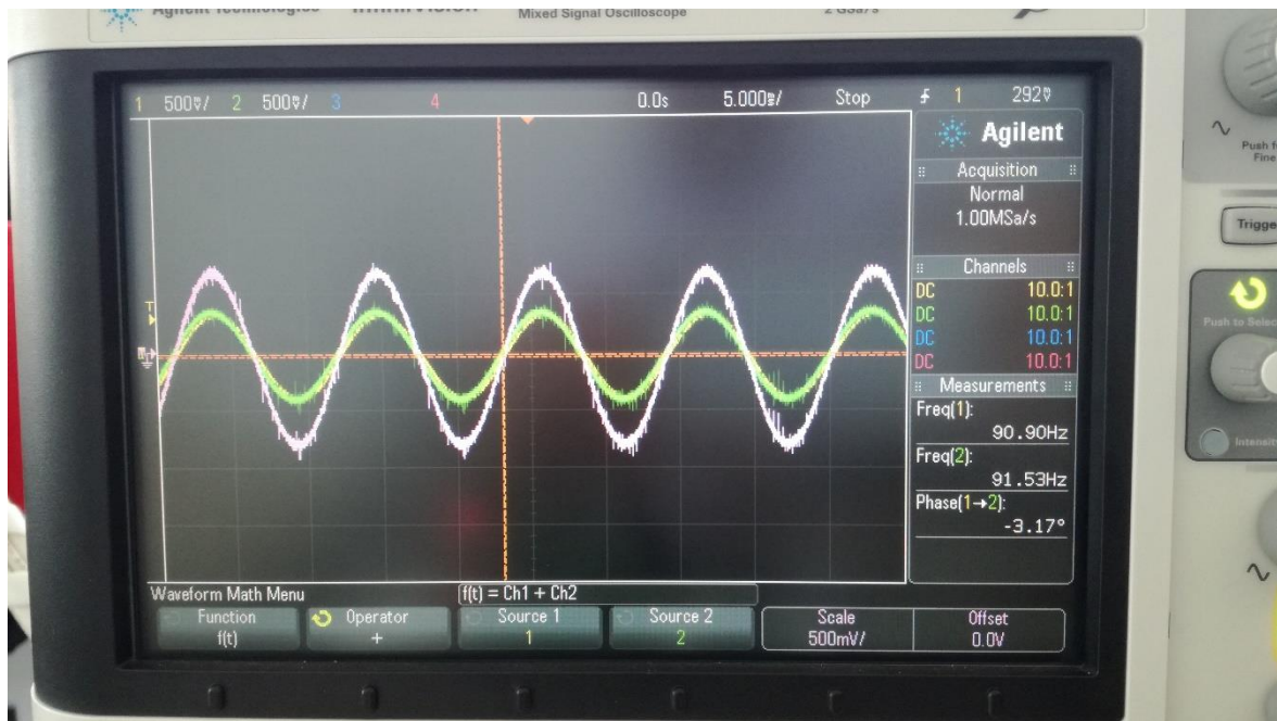
Figura 6.25 Medida en osciloscopio f=92\text{Hz} y \theta=0^\circ . Onda recibida (verde), transmitida (amarilla) y resultante (rosa)
