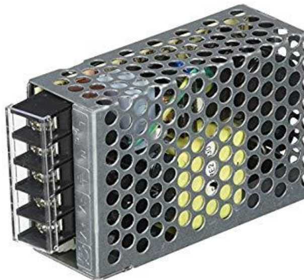
Figura 5.3 Fuente de alimentación RS-25-5 utilizada en el sistema desarrollado
