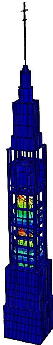
Figura 76- Modos de vibración locales en las forjados de las plantas.
